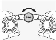
Rotirea rotitei de focalizare vă permite să focalizați pe orice obiect de la cea mai mică distanță de focalizare posibilă (a se vedea fișa de date tehnice) la infinit.
