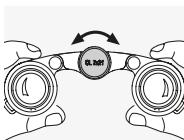
Otočením zaostrovačieho kolieska môžete zaostriť na ľubovoľný objekt od najkratšej zaostrovacej vzdialenosť (pozrite si s technickými údajmi) až do nekonečna.
