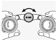
Otočením zaostřovacího kolečka můžete zaostřit na libovolný objekt od nejkratší zaostřovací vzdálenosti (viz list s technickými údaji) až do nekonečna.
