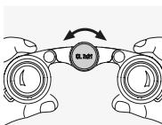
Okrećanje točkića za fokusiranje vam omogućava da fokusirate svaki predmet od najkratčeg udaljenosti fokusiranja (pogledajte dokument s tehničkim specifikacijama) do beskonačnog.
