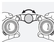
Ved at dreje på fokuseringshjulet kan du stille skarpt på et ethvert objekt fra den korteste indstillingsafstand (se det tekniske datablad) til uendeligt.
