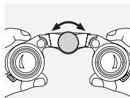
通过旋转聚焦轮，可以从最短的调整距离（见技术数据表）到无限大，将每一个物体聚焦。
