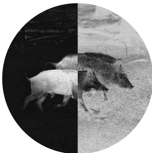
Dwa tryby obrazu wyświetlanego w termowizorze: po lewej white-hot (źródła ciepła w białym kolorze), po prawej black-hot (źródła ciepła w czarnym kolorze)
