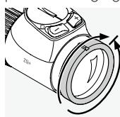
D'abord, tournez la bague de compensation dioptrique entièrement vers la gauche (dans le sens inverse des aiguilles d'une montre), puis vers la droite, jusqu'à ce que la mise au point du réticule soit optimale.
