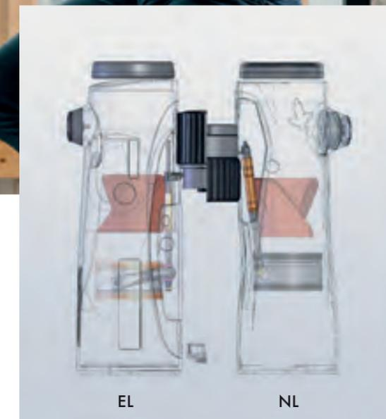
Der Unterschied zwischen der EL und der NL Pure Fernglasreihe lässt sich anhand dreier großen Parameter festmachen: 1. wurden die Prismen neu angeordnet, sodass 2. die Schubstangen schräg gelegt werden konnten. Für eine noch ergonomischere Handhabung verlegten die Konstrukteure schließlich 3. das Fokussierrad weiter nach unten.
