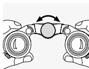
Rotirea rotitei de focalizare va permite sa focalizati pe orice obiect de la cea mai mică distanță de focalizare posibilă (a se vedea fișa de date tehnice) la infinit.
