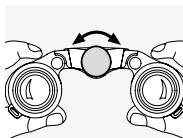
Otočením zaostrovačieho kolieska možete zaostriť na ľubovoľny objekt od najkratšej zaostrovacej vzdialenosť (pozrite si technickymi udajmi) až do nekonečna.
