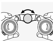
Otočením zaostřovačního kolečka můžete zaostřit na libovolný objekt od nejkratší zaostřovací vzdálenosti (viz list s technickými údaji) až do nekonečna.
