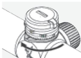
Fastlås låseringen efter brug af det ballistiske tårn, så du undgår utilsigtede ændringer af indstillingen. Det gøres ved at dreje låseringen en kvart omgang med uret.
