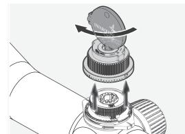
Trek de koppeling er naar boven toe af. Hiervoor kunt u ook het Schroefdraad van de muntsleutel in de koppeling schroeven, om deze er gemakkelijker af te kunnen trekken.
