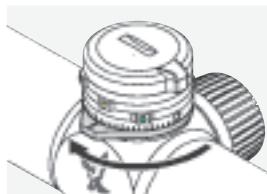
Efter användning av ballistiktornet, stäng låsningen för att undvika en oönskad justering. För att göra detta vrider ni låsringen ett kvarts varv medurs.
