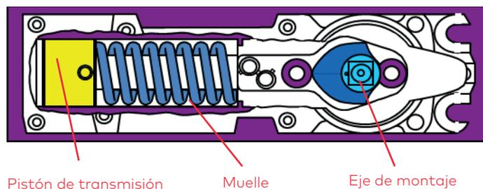
Los cierrapuertas de suelo permiten equipar puertas de todo tipo, incluso puertas de hasta 300 kg. Con el herraje apropiado permiten fabricar puertas de simple o doble acción.
