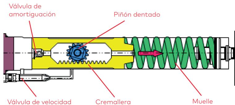
Los cierrapuertas con piñón cremallera garantizan un control total sobre la puerta. Puertas de gran envergadura o con problemas de aire tienen la solución con este tipo de mecanismos.
