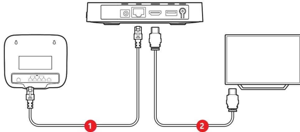
1 Ligue uma das extremidades do cabo de rede Ethernet à porta de rede da Tv Box e a outra extremidade a uma das portas de rede do Router Vodafone.
