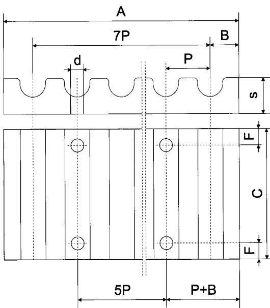
Tilausesimerkki: AT10-hamasjaon kiinnityslevy 25 mm leveälle hihnalalle.
