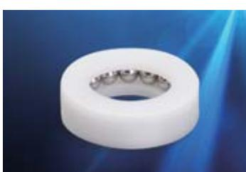
PRTB10作为通用性最强的塑料滚动轴承材料具有良好的强度和耐磨性，由于其材料自身的润滑性噪音较低；此类轴承碱性环境下表现良好但不适合在酸性环境下长期运行。标准配置内外圈材料为：改良POM，滚珠材料为：玻璃球或不锈钢（选配）；长期连续使用温度-40 ~ +80℃。
