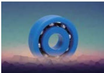
PRB25塑料滚动轴承材料是经过摩擦优化的耐磨材料，具有较低的摩擦系数；耐疲劳性较好；允许在高速下运转。耐碱、弱酸以及洗涤剂的腐蚀；标准配置内外圈材料为：改良PA，保持架材料为：改良PA，滚珠材料为：玻璃或不锈钢（选配）；长期使用温度：-40~+100℃。
