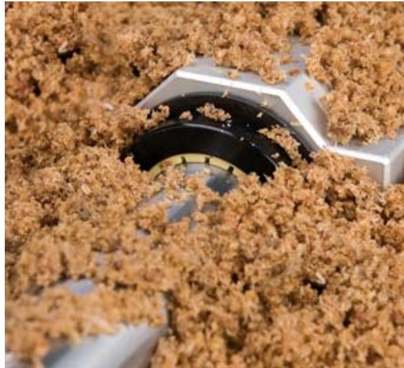
CSB-LIN®直线轴承滑动膜是由高耐磨标准材料EPB13制成；特殊的直槽结构设计允许轴承在污垢、灰尘或沙粒中平稳运行，直槽能使得脏物很快速的落入到设计的凹槽中，并通过不断的直线运动最终被从凹槽中带出直线轴承系统。而传统的金属滚动直线轴承在有污垢、灰尘或沙粒存在的情况下会很容易出现卡死、跑珠等现象而卡死，甚至会因卡死现象导致轴被拉伤。
