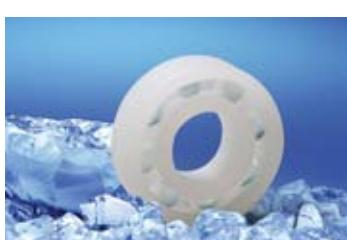
PRB20塑料滚动轴承具有低摩擦以及低温应用特性；此类轴承适合在酸碱交替环境下长期运行。标准配置内外圈材料为：改良UPE，保持架材料为：改良UPE，滚珠材料为：玻璃球或不锈钢（选配）；长期连续使用温度-150 ~ +80°C。
