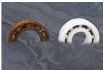
PRB10作为通用性最强的塑料滚动轴承具有良好的强度和耐磨性，由于其材料自身的润滑性噪音较低；此类轴承碱性环境下表现良好但不适合在酸性环境下长期运行。标准配置内外圈材料为：改良POM，保持架材料为：改良PA，滚珠材料为：玻璃球或不锈钢（选配）；长期连续使用温度-40 ~ +80°C。
