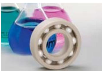
PRB30系列塑料滚动轴承具有极好的机械强度和耐磨性能，此产品能在150度的高温下正常使用，并具有极好的抗腐蚀性能几乎能在所有的腐蚀环境下运行；标准配置内外圈材料为：改良PEEK，保持架材料为：改良PEEK，滚珠材料为：陶瓷；长期连续使用温度-100 ~ +150℃。
