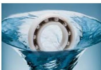
PRB15塑料滚动轴承材料具有极好的强度和耐磨性能，无论是在潮湿环境还是水下均保持良好的尺寸稳定性；对有机溶剂以及过氧化氢等具有良好的抗性；标准配置内外圈材料为：改良PETR，保持架材料为：改良PA，滚珠材料为：玻璃或不锈钢（选配）；长期使用温度：-50~+120°C。
