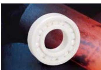
PRB40系列塑料滚动轴承具有耐高低温、高承载以及最好的抗腐蚀性能；可应用在强酸、强碱、无机、有机盐、海水等领域。标准配置内外圈材料为：陶瓷，保持架材料为：改良PTFE或改良PEEK，滚珠材料为：陶瓷；长期连续使用温度-200 ~ +250℃。
