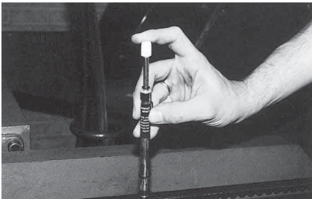
Kireyden mittaaminen GATES-kireysmittarilla.
