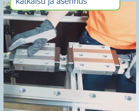
Lineaarijohteiden katkaisu ja asennus
