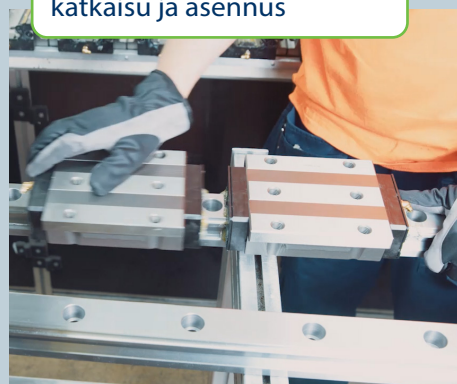
Lineaarijohteiden katkaisu ja asennus
