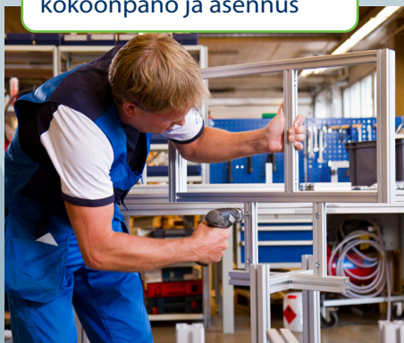
Alumiiniprofilien katkaisu, kokoonpano ja asennus
