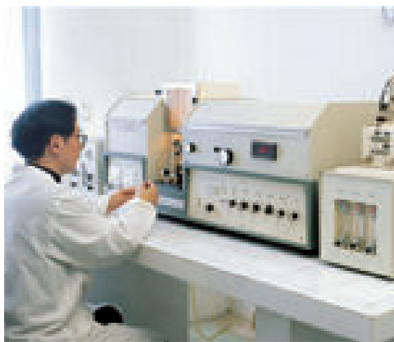
原子吸收分光光度计（中国） Atomic absorption spectrophotometer (China)
