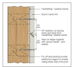
FIGURE 10 SCYON™ CAVITY TRIM BUTT DETAIL
