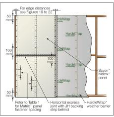
FIGURE 15 MATRIX PANEL FASTENERS
