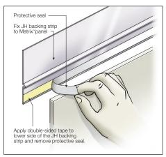
FIGURE 12 DOUBLE SIDED BACKING TAPE OPTION 2
