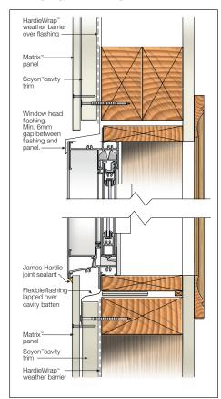
FIGURE 24 WINDOW HEAD/SILL DETAIL
