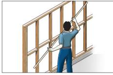
FIGURE 1 FRAME STRAIGHTNESS
