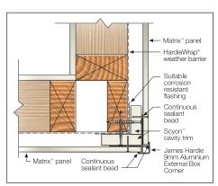
FIGURE 26 SCYON MATRIX EXTERNAL BOX CORNER DETAIL
