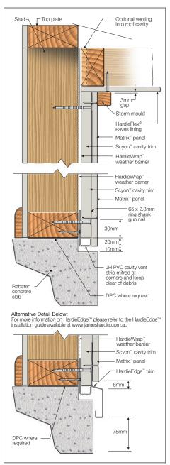
FIGURE 23 SLAB/EAVES DETAIL
