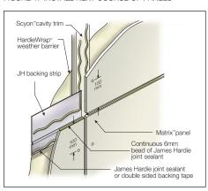
FIGURE 18 JOINT SEALANT PREPARATION
