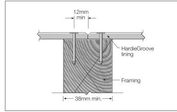
FIGURE 11 BUTT JOINT
