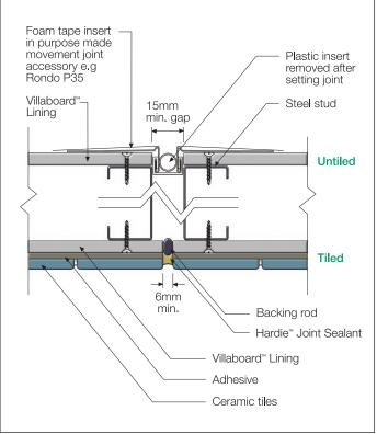
FIGURE 15 CONTROL JOINT
