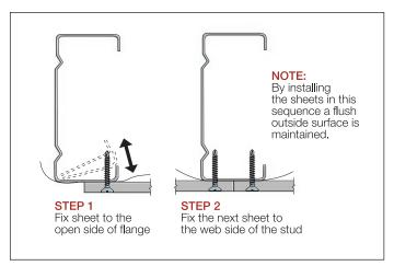
FIGURE 7 SCREW FASTENING
