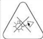
**(S)** Armaturen bör placeras så att långvarigt tittande direkt in i armaturen inte förväntas på ett avstånd närmre än 1 m.
