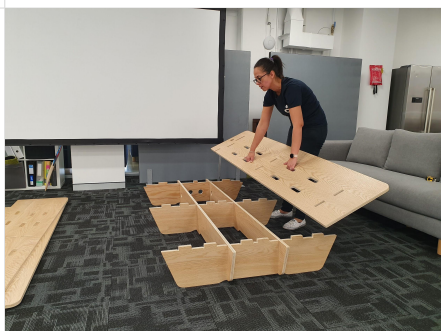
Step 5: 残りの床板を取り外し、他の2つの床板の上に重ねるように乗せる
