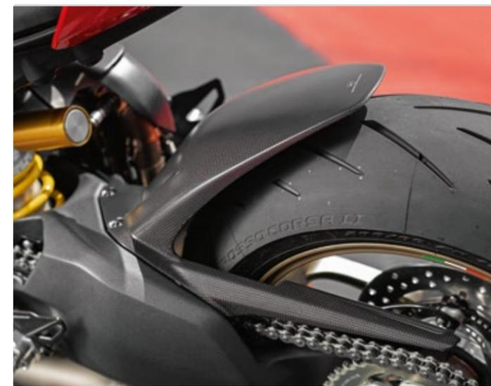
2 Hinterer Kotflügel aus Kohlefaser
