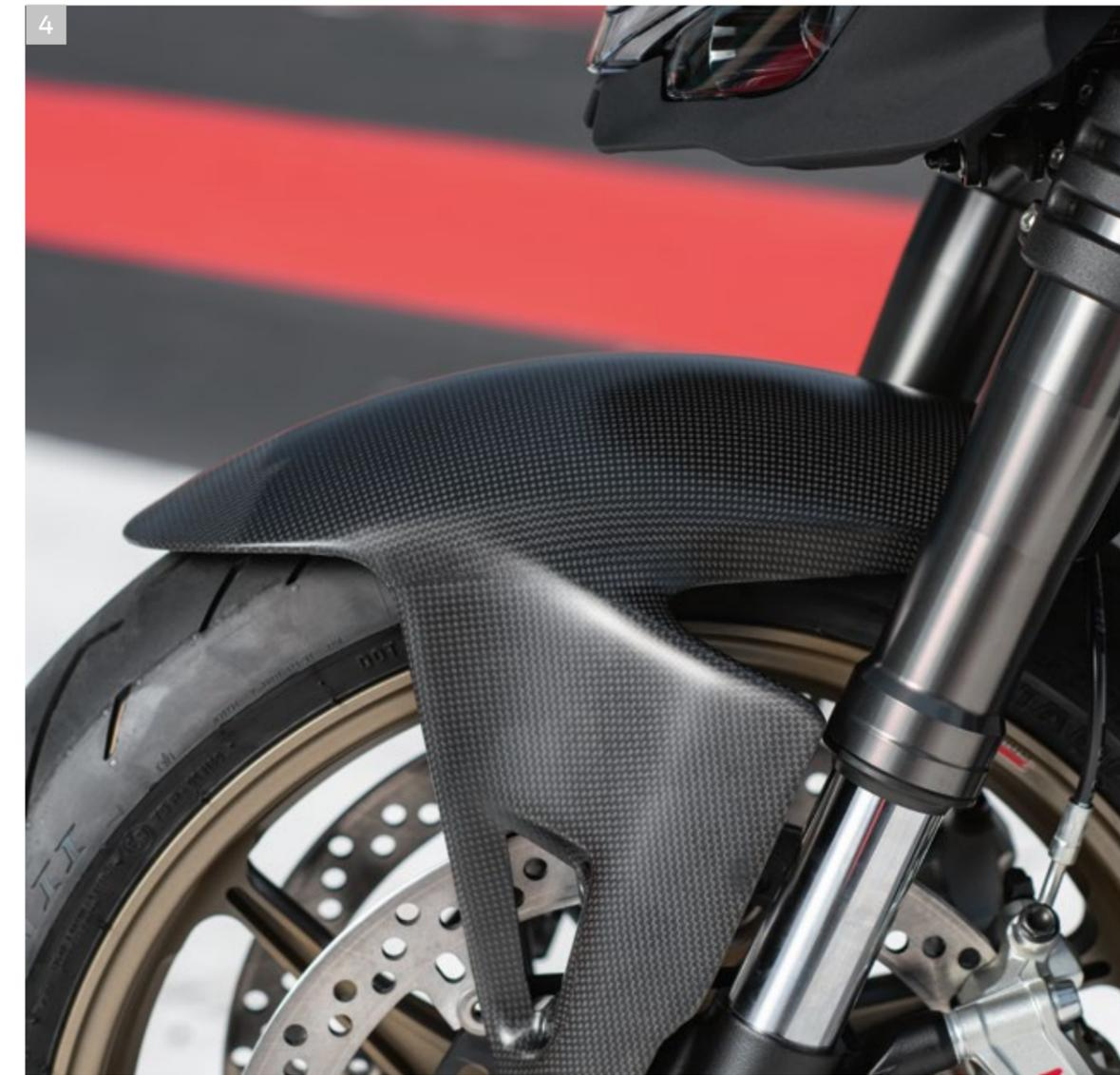
3 Vorderer Kotflügel aus Kohlefaser
