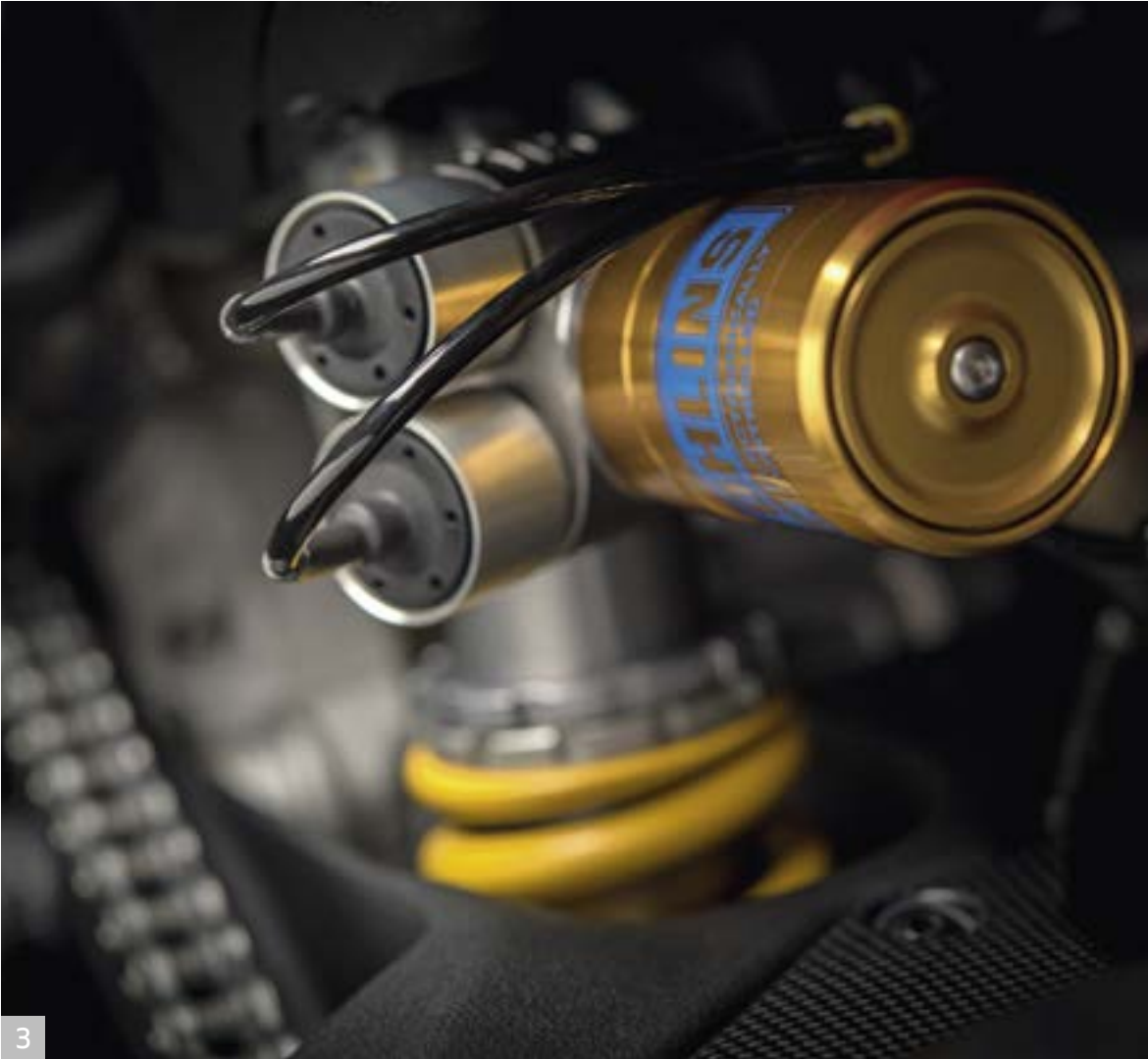
3 Ammortizzatore Öhlins Smart EC TTX36
