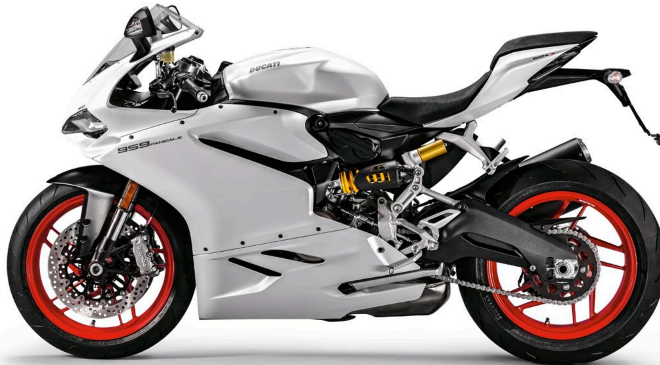
Un leggerissimo telaio monoscocca, il motore bicilindrico con funzione portante, quote ciclistiche studiate per offrire il massimo feeling di guida. Il tutto volto a trovare l'equilibrio dinamico perfetto sia nella guida in strada sia in quella in pista. Il forcellone con perno abbassato e l'interasse ottimizzato lavorano all'unisono con sospensioni evolute come la forcella Showa BPF da 43 mm e il monoammortizzatore Sachs, entrambi pluriregolabili.
