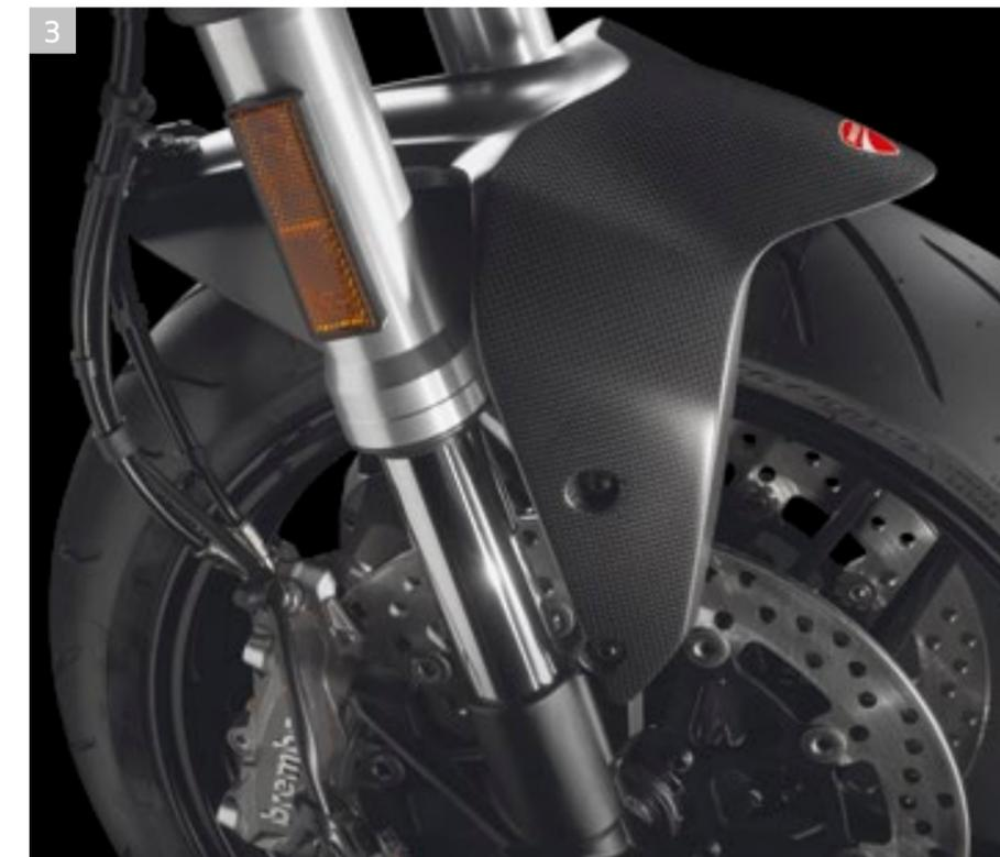
3 Garde-boue avant en fibre de carbone
