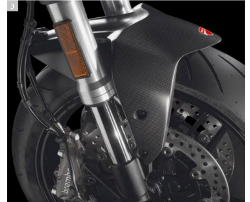
3 Vorderer Kotflügel aus Kohlefaser
