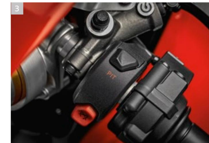
1 Réservoir en aluminium brossé 2 Amortisseur Öhlins TTX36 entièrement réglable 3 Bouton d'activation du Pit Limiter (PIT)
