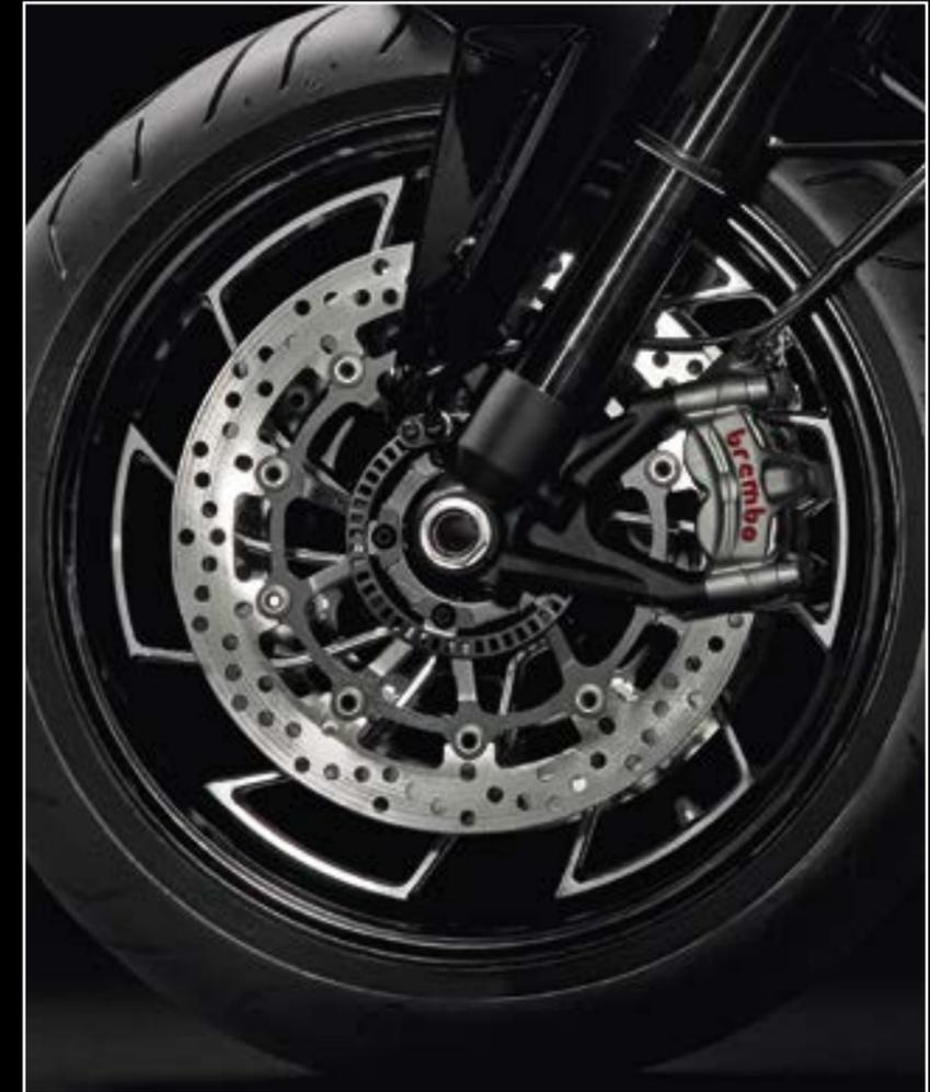
L'XDiavel è dotata di impianto frenante Brembo con dispositivo ABS Cornering di Bosch di serie. Le prestazioni frenanti all'anteriore sono garantite da pinze monoblocco radiali azionate da una pompa freno radiale dotata di serbatoio integrato e da due dischi semi-flottanti da 320 mm di diametro. Al posteriore, invece, il disco da 265 mm è frenato da una pinza a due pistoncini.
