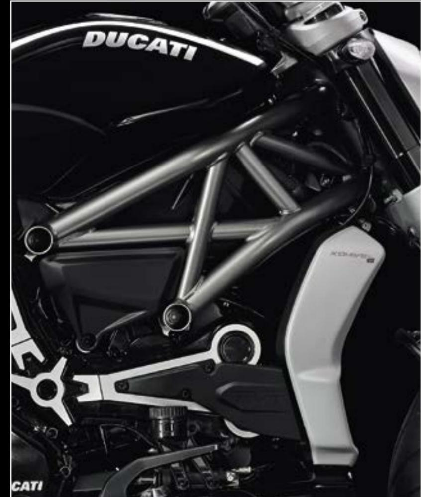
Il telaio dell'XDiavel è un traliccio in tubi d'acciaio collegato alle teste del motore, che diventa, così, elemento stressato della ciclistica.
