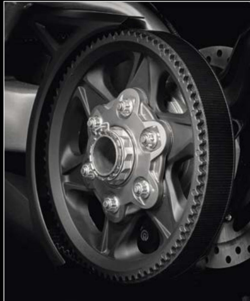
L'XDiavel è la prima Ducati a utilizzare la trasmissione finale a cinghia: un must nel mondo cruiser. Il sistema è stato sviluppato per l'XDiavel in modo da poter garantire in maniera affidabile e sicura la trasmissione della potenza erogata dal Ducati Testastretta DVT 1262. I vantaggi della cinghia sono silenziosità, pulizia, ridotta manutenzione e risposta fluida alle variazioni di apertura del gas.
