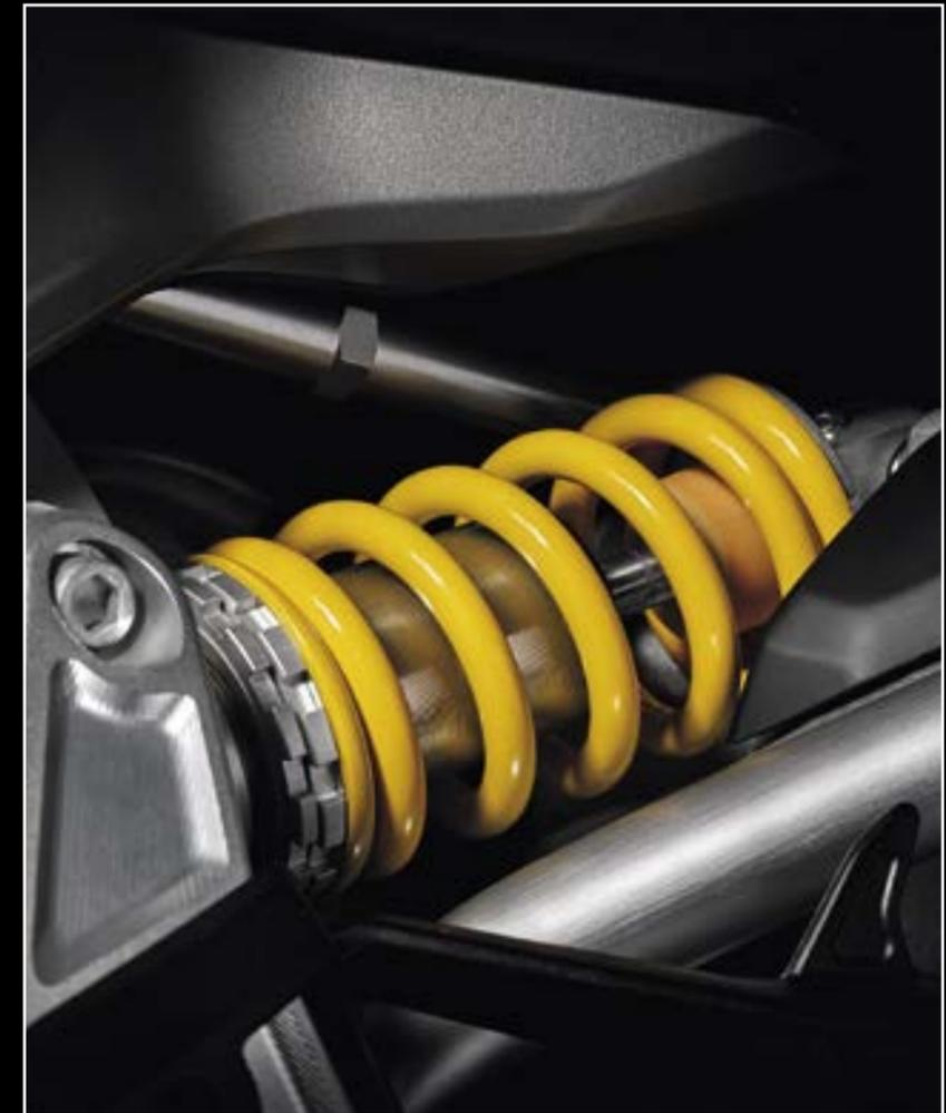
L'XDiavel monta all'anteriore una forcella completamente regolabile da 50 mm di diametro con foderi anodizzati neri e riporto DLC (su versione S). Al posteriore un ammortizzatore regolabile dotato di serbatoio remoto è montato in posizione quasi orizzontale e lavora assieme a un cinematismo progressivo. Le sospensioni, sia all'anteriore che al posteriore, inoltre, sono state riviste in modo da garantire ancora più comfort, senza rinunciare a precisione ed efficacia.
