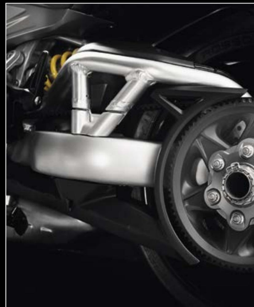
Il forcellone monobraccio dell'XDiavel è realizzato combinando tre tecnologie differenti nello stesso componente. La parte inferiore è fusa, mentre quella superiore è composta da un traliccio di tubi e da un elemento forgiato estraibile che permette la sostituzione della cinghia di trasmissione.
