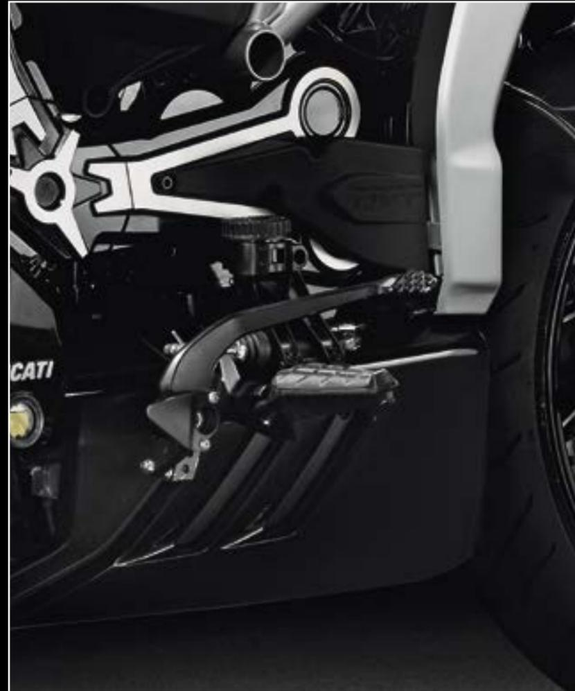
Le pedane avanzate dell'XDiavel sono regolabili, di serie, su tre posizioni. Come accessorio, sono disponibili un kit pedane centrali e un kit pedane arretrate, entrambe ulteriormente regolabili, in modo da garantire l'ergonomia migliore per ogni pilota.
