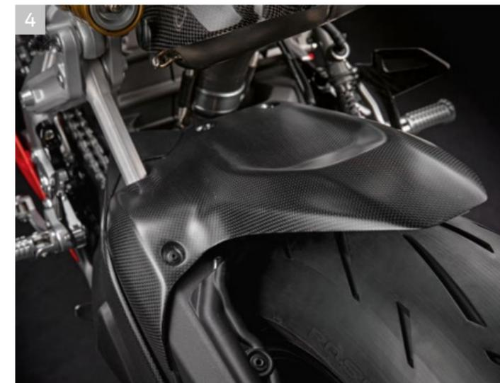
4 Hinterer Kotflügel aus Kohlefaser.
