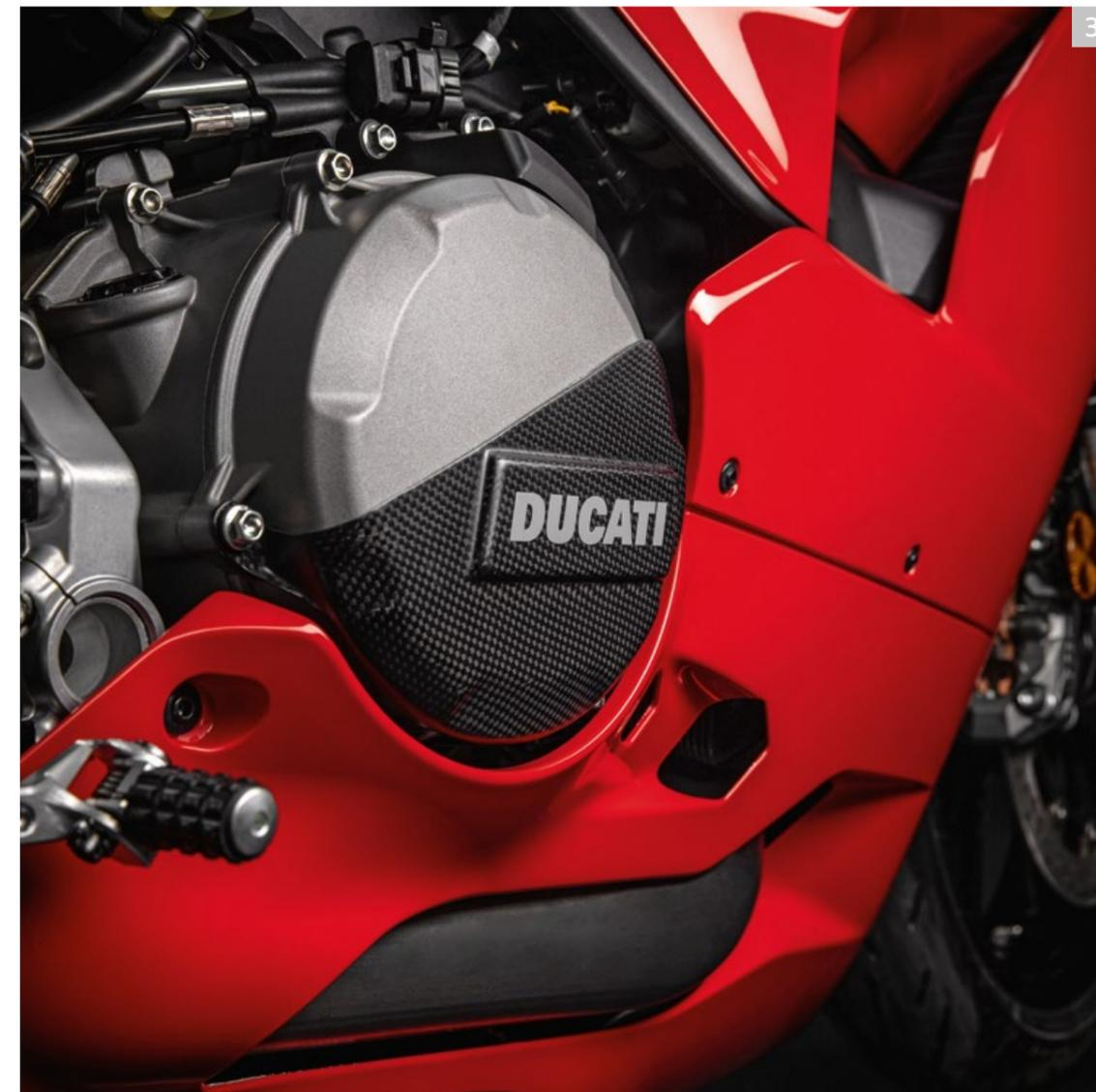
3 Schutz aus Kohlefaser für Kupplungsdeckel.
