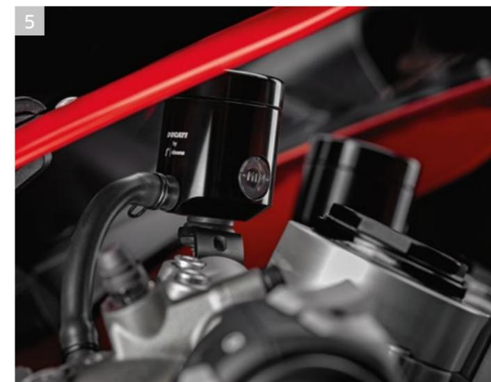
5 Kupplungsflüssigkeitsbehälter. Bremsflüssigkeitsbehälter.
