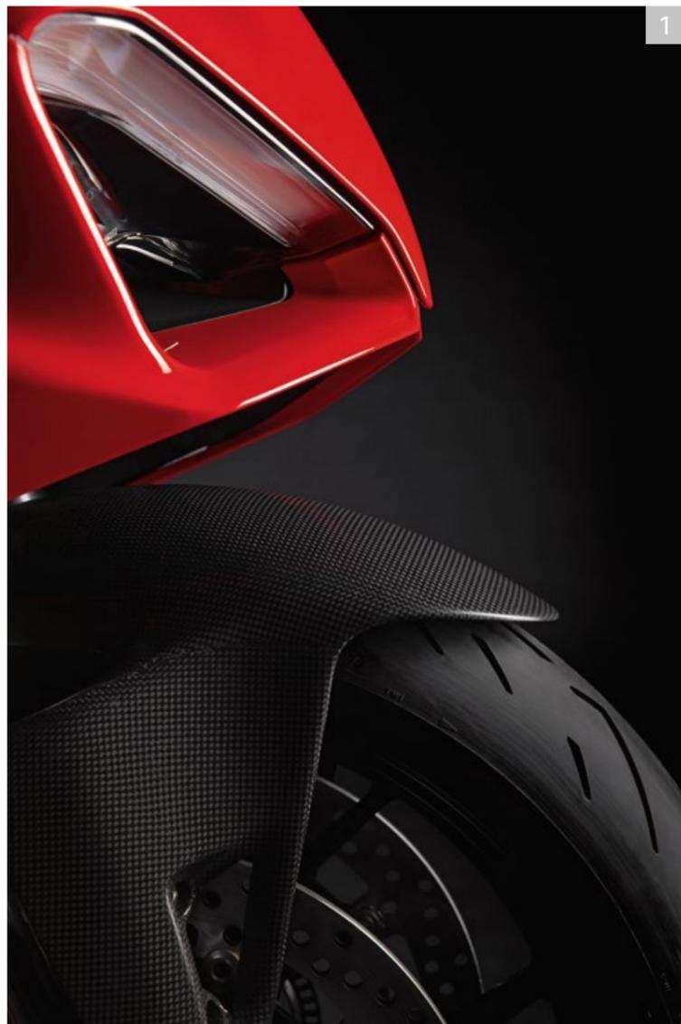
1 Vorderer Kotflügel aus Kohlefaser.
