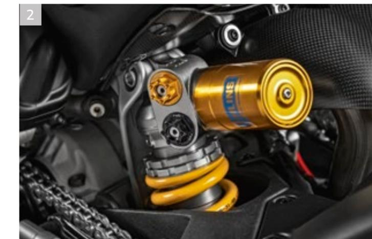
2 Ammortizzatore Öhlins TTX36 completamente regolabile
