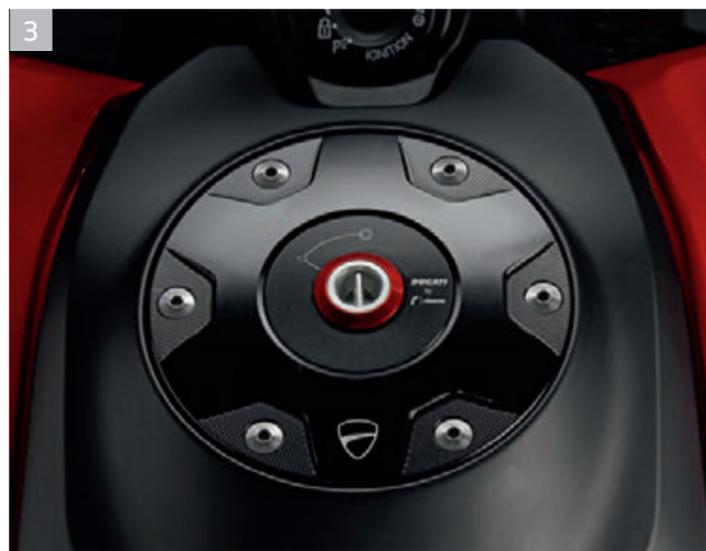
3 Bouchon du réservoir en aluminium usiné dans la masse
