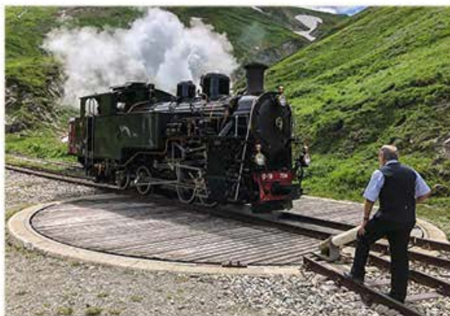
In der Station Furka gibt es eine handbediente Drehscheibe, auf der die Loks gedreht werden können. Foto: Michael Appelt
