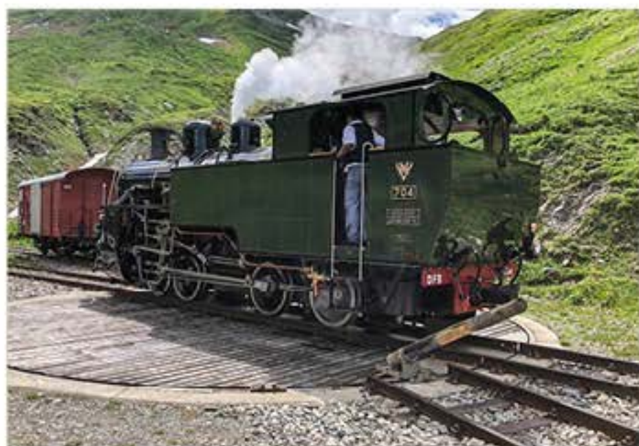
In der Station Furka gibt es eine handbediente Drehscheibe, auf der die Loks gedreht werden können. Foto: Michael Appelt
