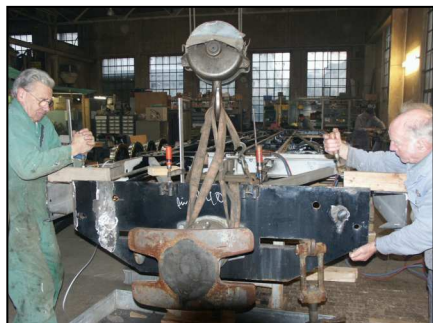
Montage der Puffer
