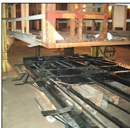
Aufsetzen des LSE-Kastens auf das revidierte Chassis des BVZ J 2407
