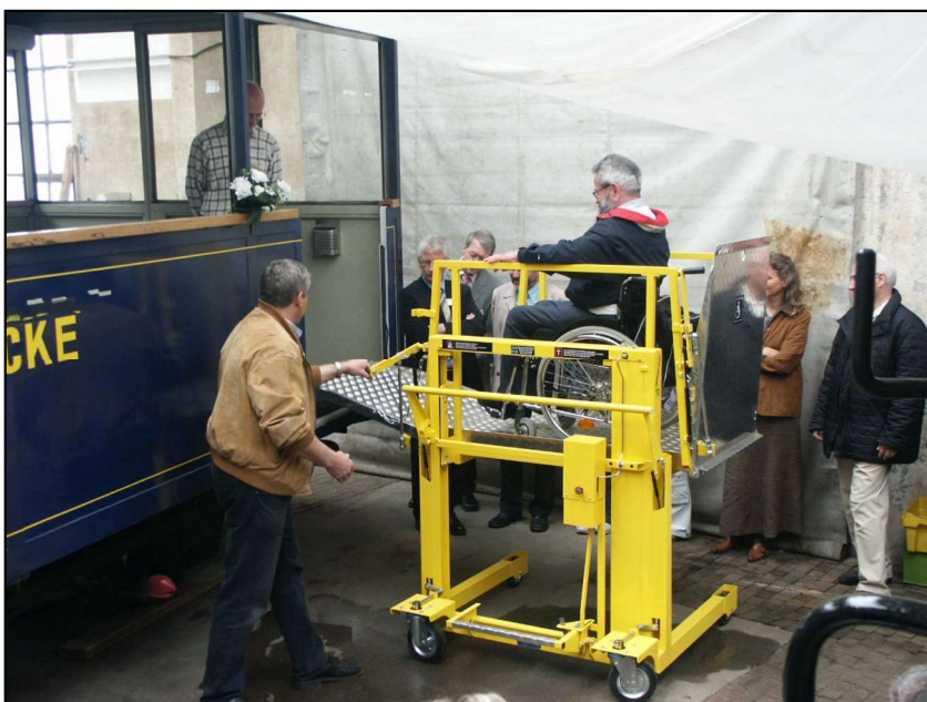
Mit den Hebeliften der SBB können Behinderte auf Rollstühlen bequem und gefahrlos zusteigen
