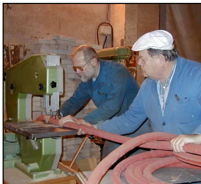
Zusägen der Heizungsschläuche
