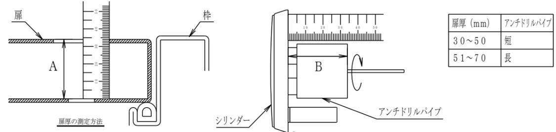
※Aの寸法よりBの寸法が長い場合、シリンダーが扉より浮いてしまうのでBの寸法は必ずAと同寸法か若干短くしてください。
