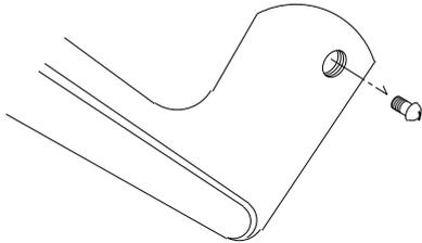
②錠本体を固定している室内側のネジ (4本) を外し、扉から錠本体を外します。
