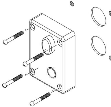
③既存のシリンダー取付ネジを外し、シリンダーを錠本体から外します。
