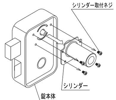
④『dormakaba』のロゴを上向きにして錠本体にはめ込み、付属のシリンダーネジセットを使用して錠本体に取り付けます。
