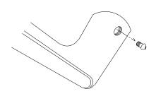
※部品を落として無くさないようにして ください。 ②錠本体を固定している室内側のネジ(3本)を外し、扉についている取付座から錠本体を外します。
