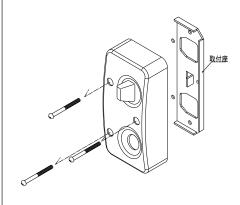
③既存のシリンダー取付ネジを外し、 シリンダーと押え板を錠本体から外 します。
