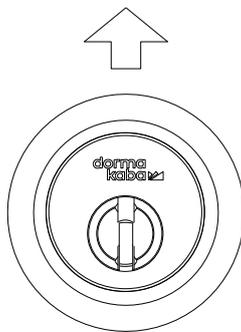
④シリンダーを固定する前に、施錠、解錠操作でキーが抜けることを確認し、取外しと逆の要領で、室内側から既存のシリンダー固定ネジで固定します。
