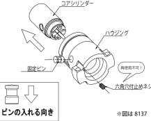
④入替用コアシリンダーを入れ直し、③の逆の 手順でコアシリンダーを固定します。 ⑤飾りリングを取り付けます。ハウジングの溝 に合わせて、飾りリング止め輪を差込み、バネ を押えながら、飾りリングをはめ込みます。
