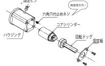
②ハウジング後部にある六角穴付止めネジを緩 め、固定ピンを外し、後部からコアシリンダー を引き出します。
