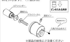
④逆の手順でコアシリンダーの入替を行います。 ※コアシリンダーに連結カム+ドライバーを重ね 上からハウジングを被せる方法をお勧めします。
