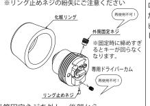
④外筒固定ネジを外し、後部から コアシリンダーを抜き取ります。
