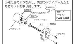
②ハウジング後部にある六角穴付止めネジを緩 め、固定ピンを外し、後部からコアシリンダー を引き出します。
