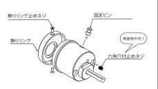
②ハウジング後部の六角穴付止めネジを緩め、 シリンダー固定ピンを外し、そのまま前部より コアシリンダーを抜き出します。
