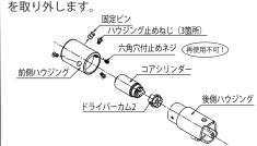
②前側ハウジングの後部にある六角穴付止めネ ジを緩め、固定ピンを外し、後部からコアシリ ンダーを引き出します。
