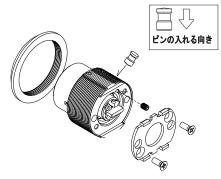
⑥外したシリンダー固定プレートを 取付ネジで取り付け、前部からネジリ ングを取り付けます。
