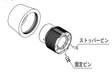
⑤コアシリンダーを入れ直し、固定ピンでハウジングとコアシリンダーを固定し、後部から未使用の六角穴付止めネジで取り付けます。緩まないようにしっかりと固定し、コアシリンダーが動かないかを確認してください。
