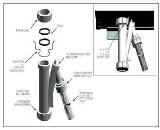
Fig. 10: Condensate Trap
