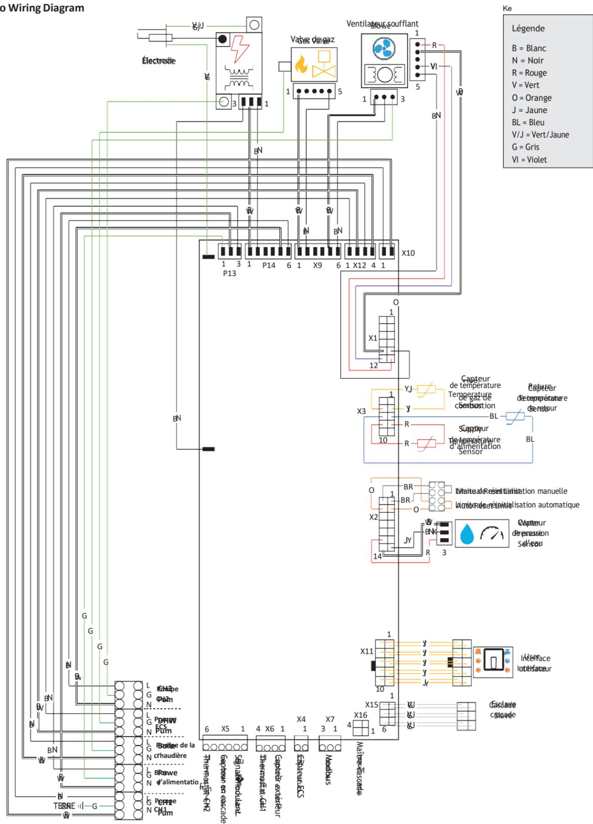
Fig. 22 - Câblage en usine de la chaudière INSTINCT Solo
