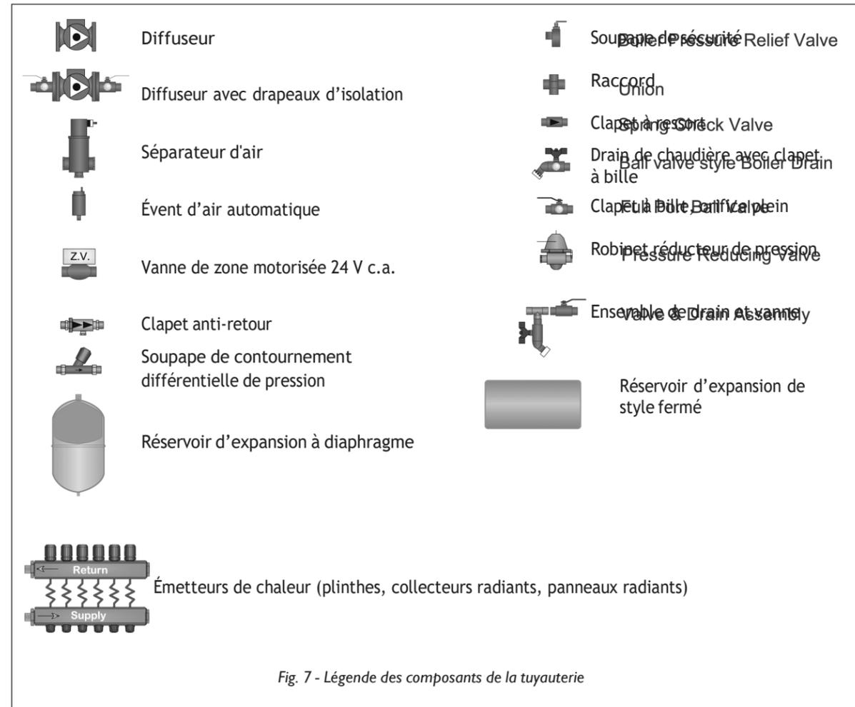
Fig. 7 - Légende des composants de la tuyauterie
