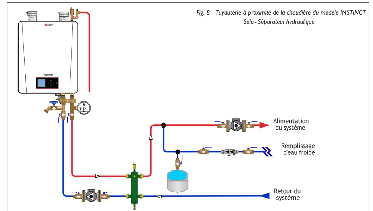
Fig. 8 - Tuyauterie à proximité de la chaudière du modèle INSTINCT Solo - Séparateur hydraulique
