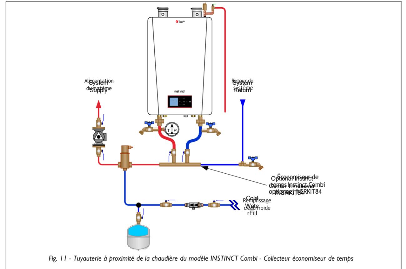
Fig. 11 - Tuyauterie à proximité de la chaudière du modèle INSTINCT Combi - Collecteur économiseur de temps
