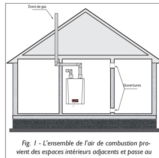
Fig. 1 - L'ensemble de l'air de combustion provient des espaces intérieurs adjacents et passe au travers d'ouvertures.
