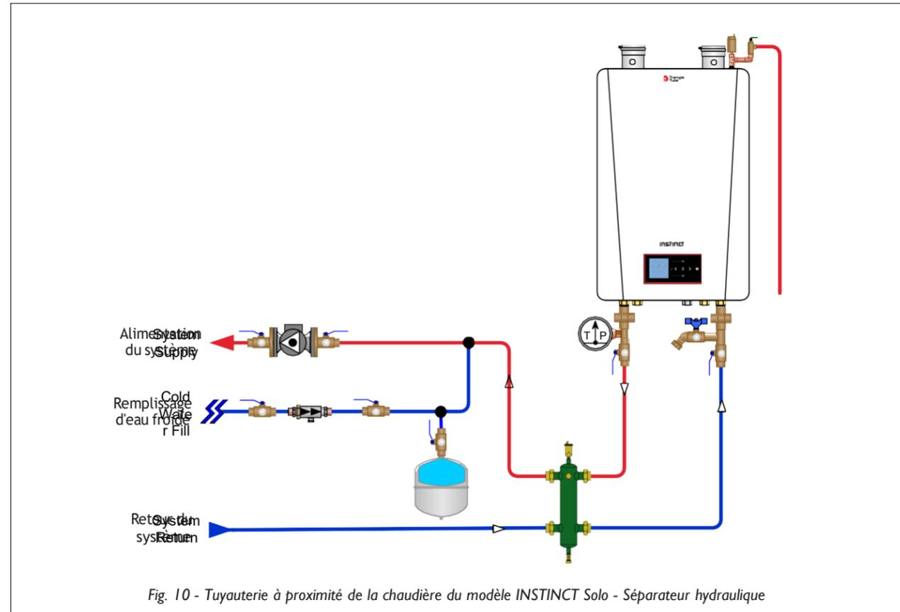
Fig. 10 - Tuyauterie à proximité de la chaudière du modèle INSTINCT Solo - Séparateur hydraulique
