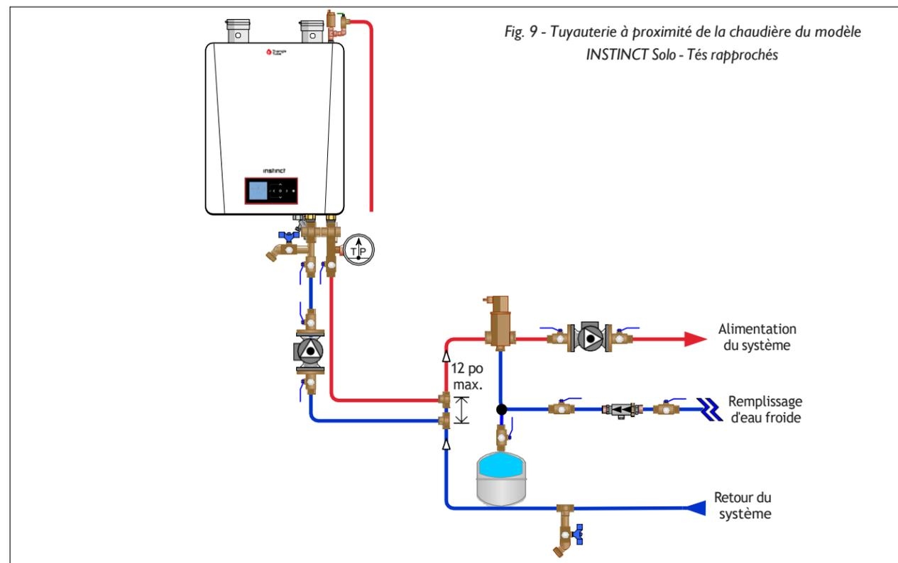
Fig. 9 - Tuyauterie à proximité de la chaudière du modèle INSTINCT Solo - Tés rapprochés
