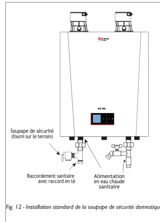
Fig. 12 - Installation standard de la soupape de sécurité domestique
