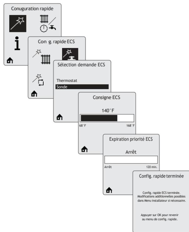
Lorsque **Capteur** est sélectionné dans Sélection demande ECS, l'utilisation d'un capteur de chauffe-eau indirect (en option) est requise. La chaudière INSTINCT surveille la température de stockage de l'ECS et génère une demande d'ECS chaque fois que la température chute sous la consigne de stockage de l'ECS de 6 °F [3 °C].
