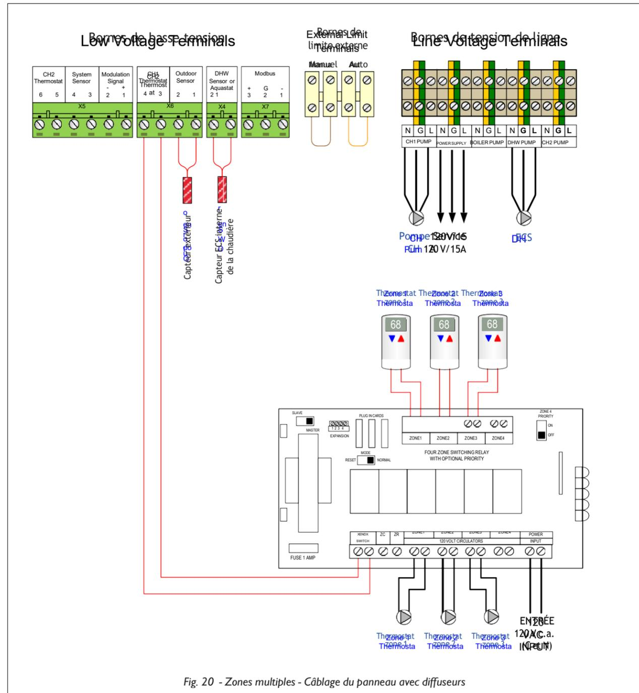
Fig. 20 - Zones multiples - Câblage du panneau avec diffuseurs
