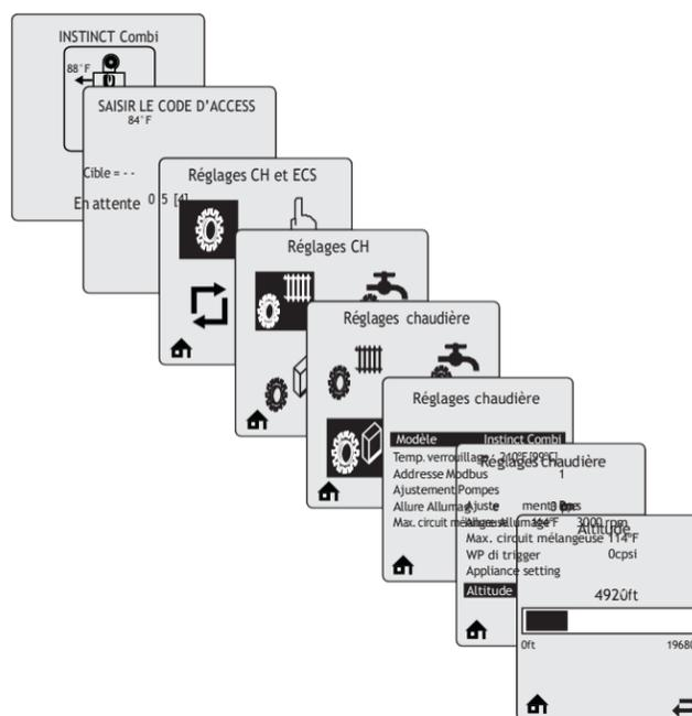
**Altitude** doit être correctement réglé pour permettre le fonctionnement fiable de la chaudière.
