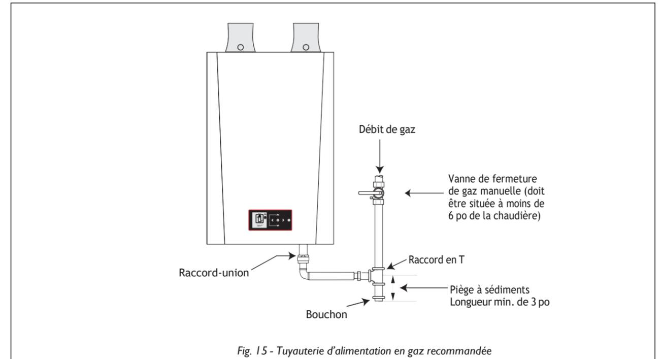
Fig. 15 - Tuyauterie d'alimentation en gaz recommandée
