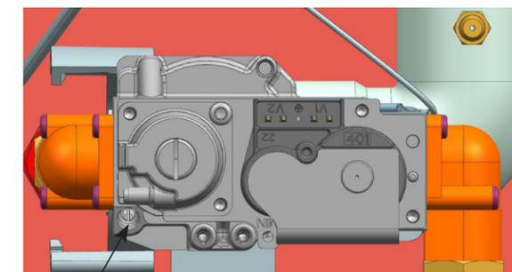
Vis de papillon Fig. 27- Emplacement de la vis de papillon
