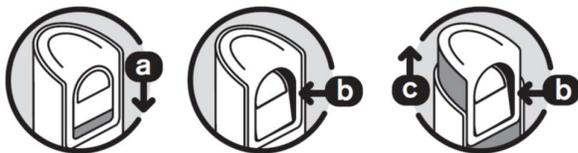
1. Большим пальцем плавно опустите вниз кнопку дозатора, как показано на рисунке (а), до возможности нажатия кнопки внутрь (см. рис. b).
