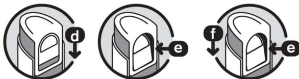
1. Плавно опустите вниз кнопку дозатора, как показано на рисунке (d), до возможности нажатия кнопки внутрь (e).
