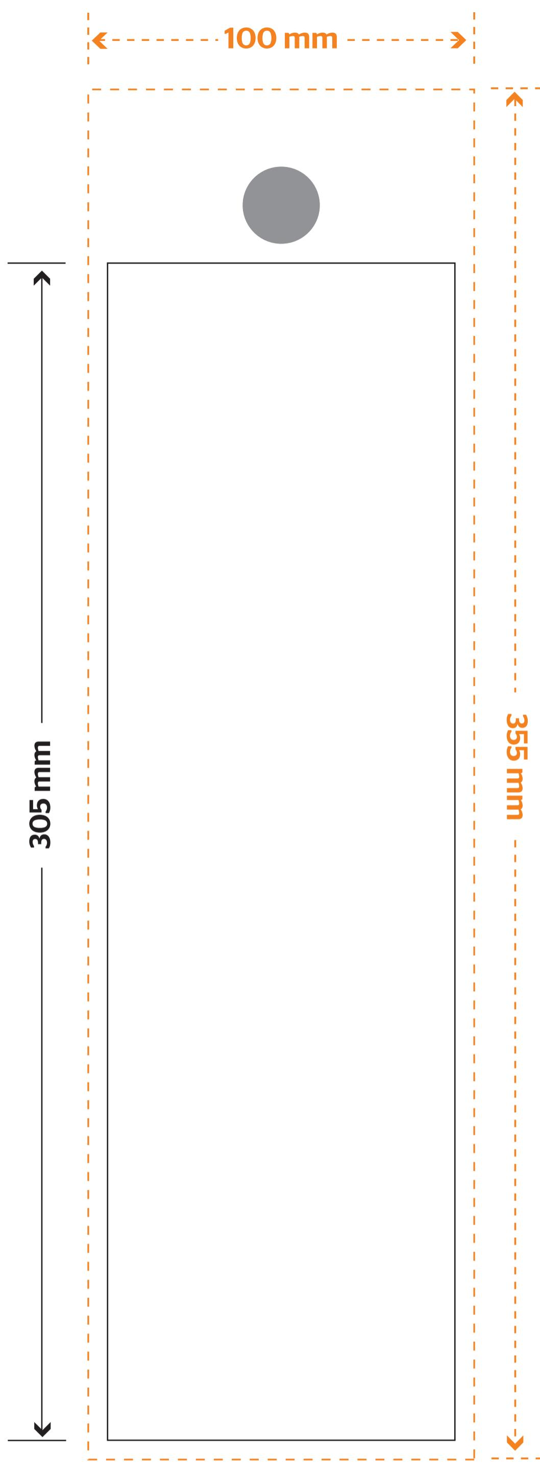
Dimensions caisse à vin, également le format à délivrer (100 x 355 mm)
