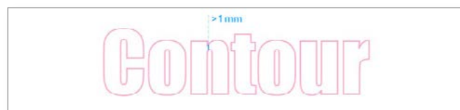
Zorg dat de te snijden vorm geen delen bevat die dunner zijn dan 1 mm
