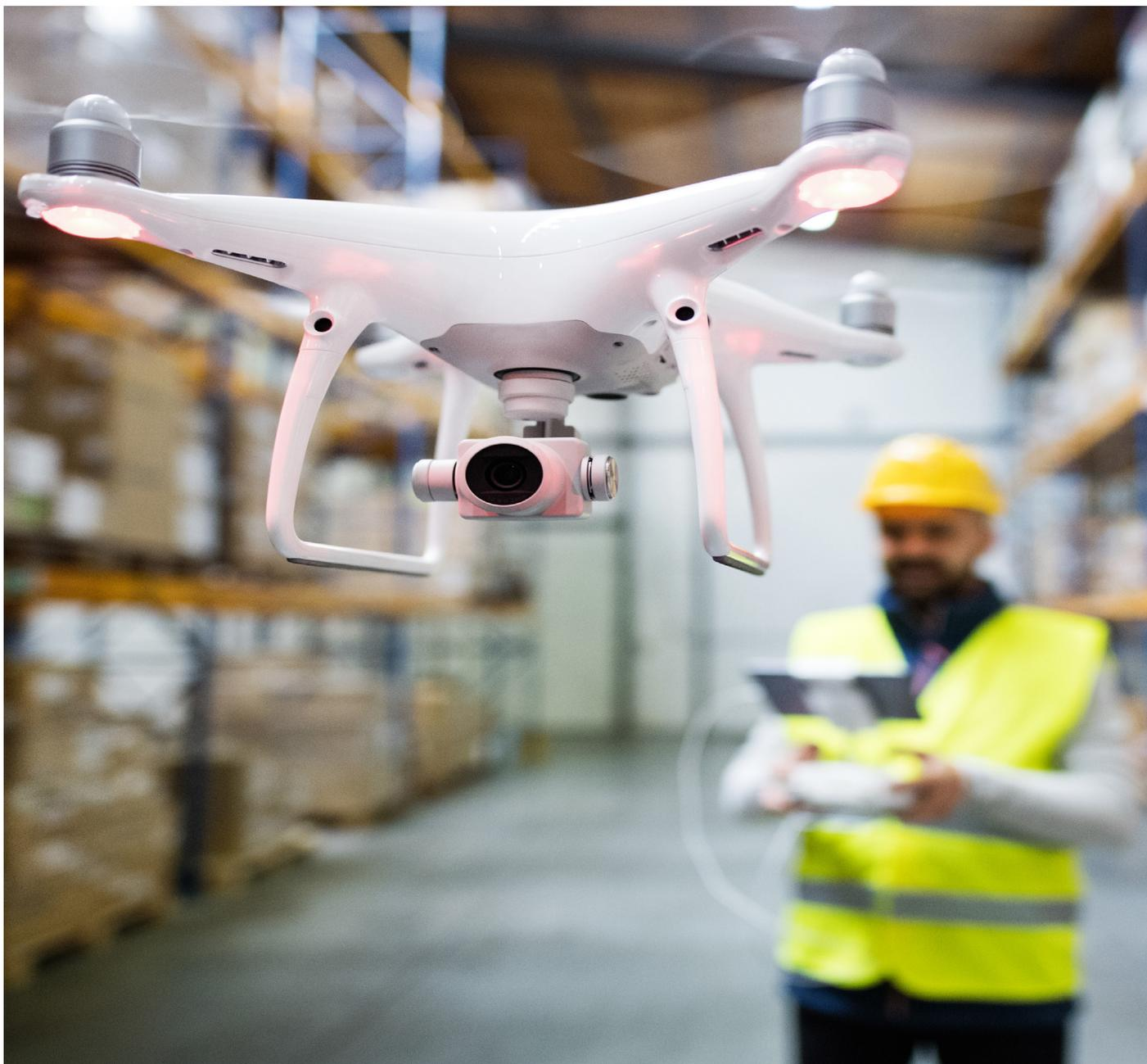
5. L'autonomie des drones utilisés dans ce type d'application est de l'ordre 25 minutes. Avec une flotte de plusieurs drones, les appareils se relaient et les temps de charge n'interrompent pas l'exécution du plan de vol.
