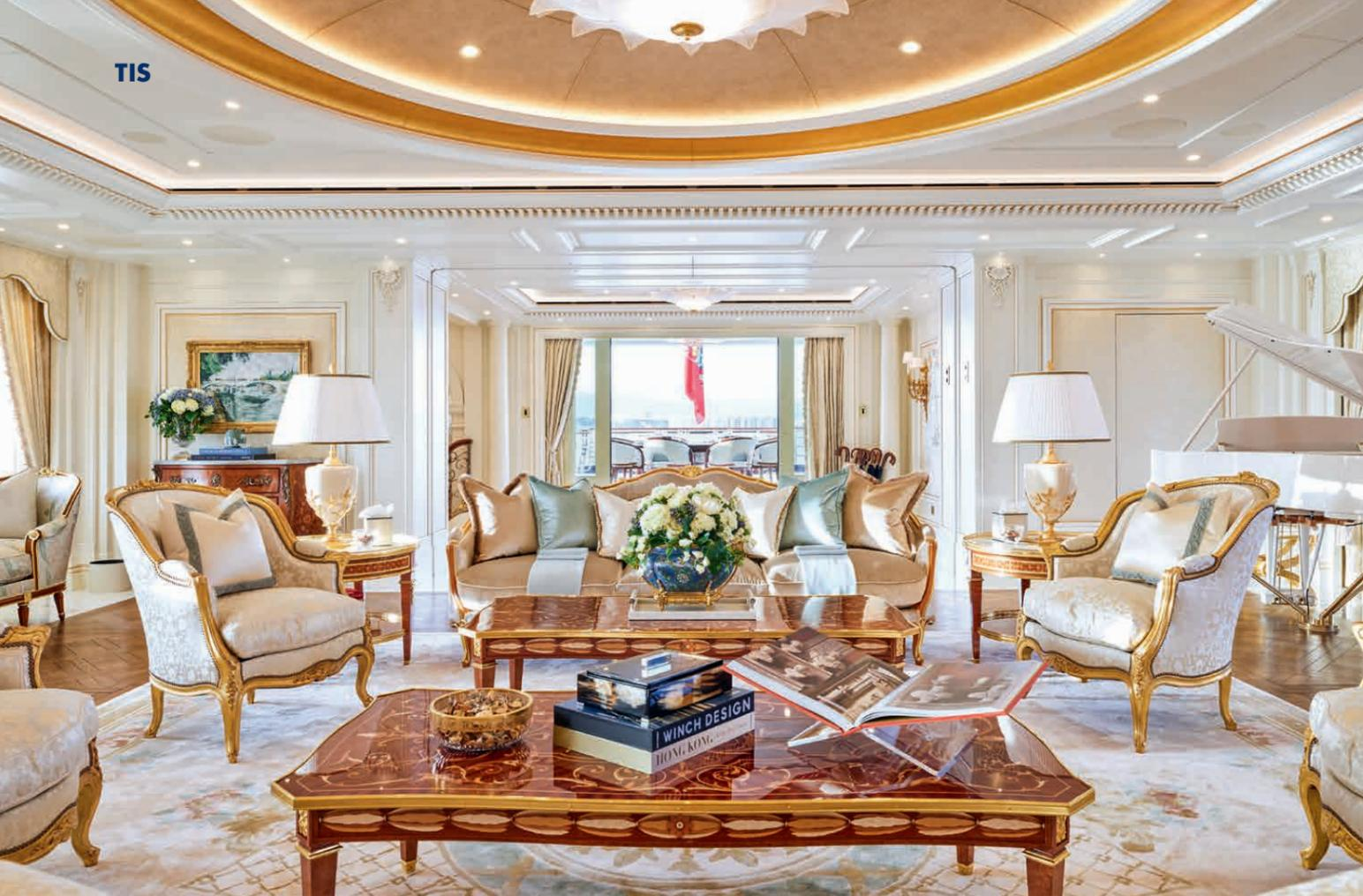
Hauptdecksalon: Aufgrund der strengen PYC-Vorgaben bestehen Wand- und Deckenpaneele aus Blähglas, das nicht brennbar ist und mit Strichlack versehen eine perfekte Holzillusion erzeugt. Der Spirio-Flügel von Steinway & Sons spielt wie von Geisterhand.
