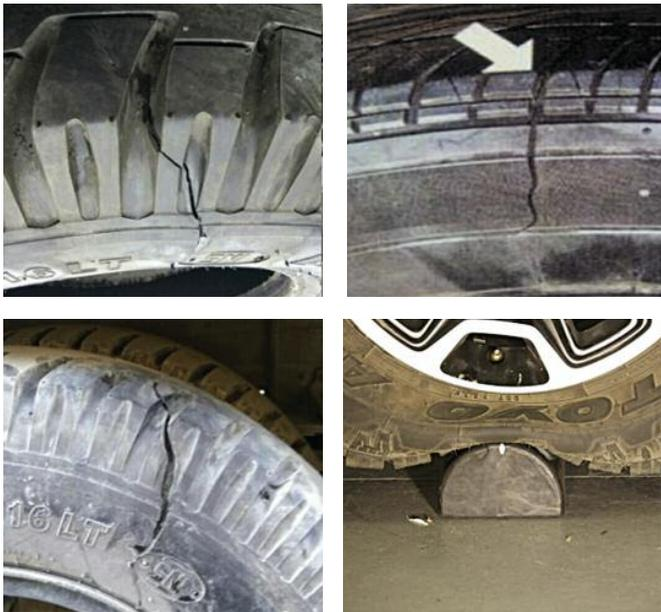
**SHOULDER CRACK (PUNDAK BAN RETAK)**
