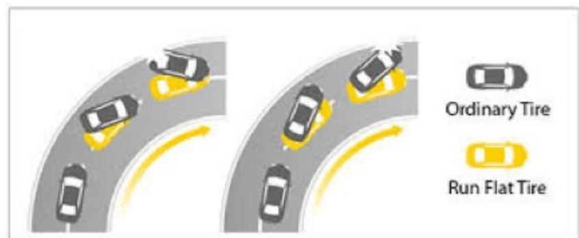
Perbedaan kontrol traksi antara ban konvensional dengan run flat tire pada saat kehilangan tekanan udara.
