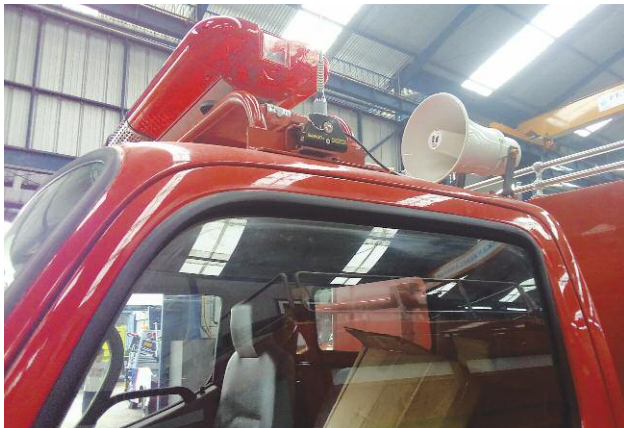
Sirine dan Rotari khas pemadam kebakaran
